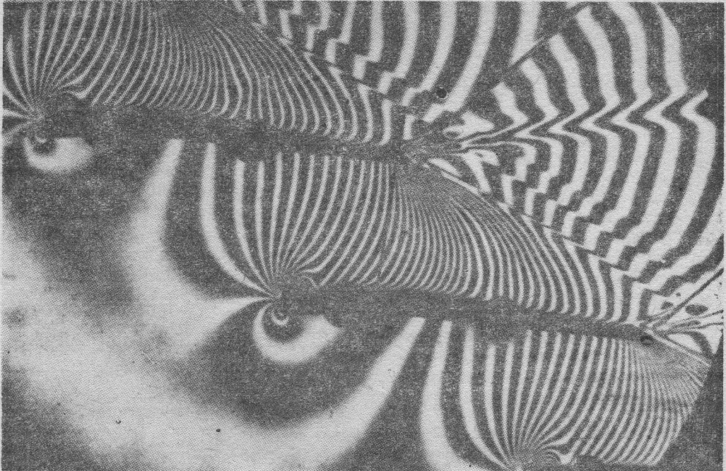
Rys. 1. Zdjęcie interferencyjne przepływu przez palisadę profili wierzchołkowych ostatniego stopnia turbiny dużej mocy [7]
