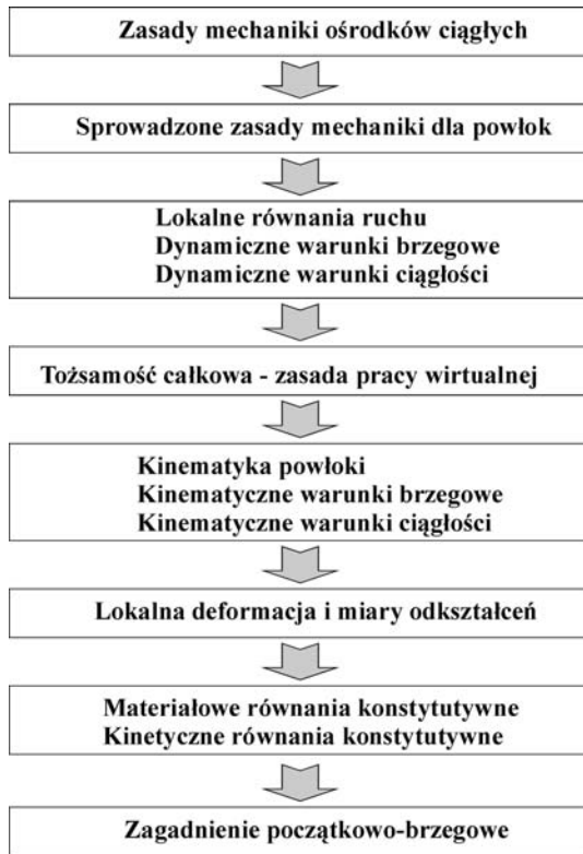
Rys. 1.2.2. Schemat formułowania mechaniki powłok.
