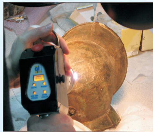
Laserowe usuwanie warstwy wosku z elementu figury św. Jerzego (XVI w.).
