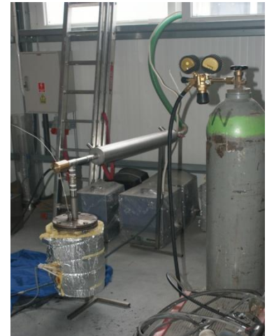
Fot. 10 Podawanie CO 2 w procesie zgazowania
