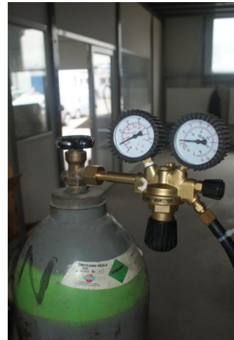
Fot. 10 Podawanie CO 2 w procesie zgazowania
