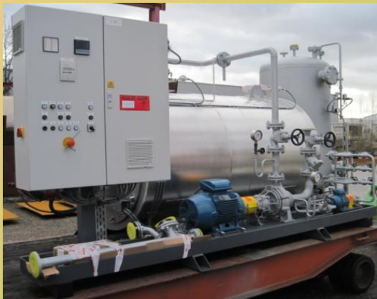
Kocioł podgrzewający olej termalny – źródło ciepła układu ORC
