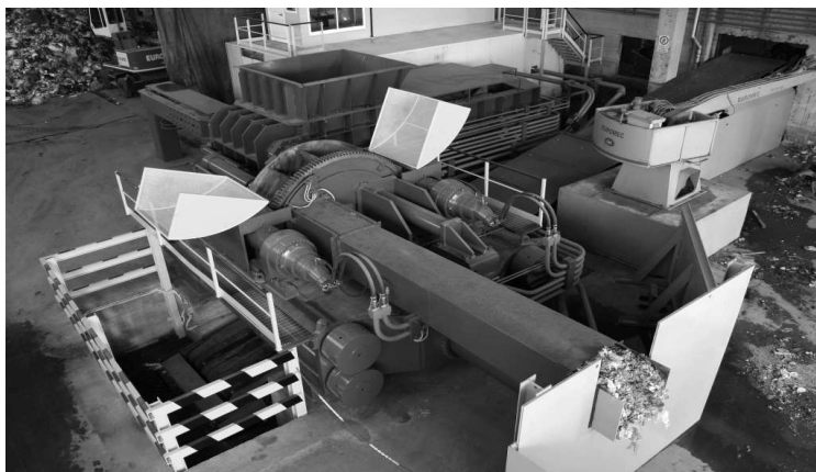
Rys. 1. Alessandria, Włochy. Praso-ekstruder VM 2035 do obróbki zmieszanych odpadów komunalnych,
