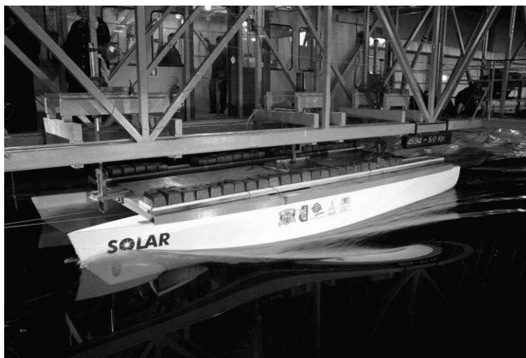
Rysunek 1. Badania obiektu rzeczywistego katamaranu SOLAR na basenie w Centrum Techniki Okrętowej
