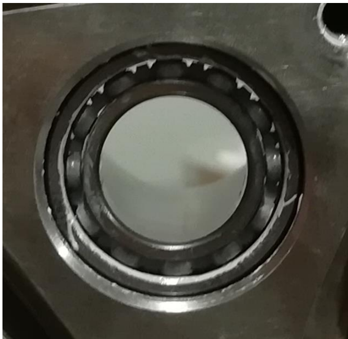
Rys. 3-40 Zbliżenie na pierwotny typ łożyska osadzonego w korpusie prototypu z widocznymi wyciekami medium smarującego.
