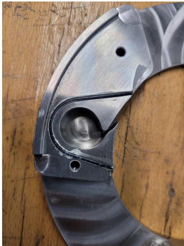
Rys. 3-37 Zbliżenie na wykonaną dyszę wraz z jej kanałem dolotowym w skrzyni dyszowej.
