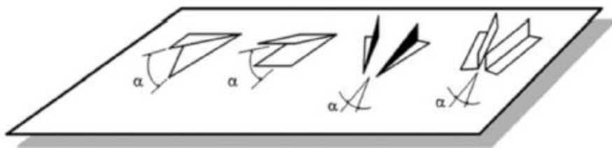
Rys. 1.11. Przykłady geometrii generatorów wirów. Od lewej: kształt skrzydła delta, kształt prostokątny, delta symetryczne, prostokątne symetryczne [42]
