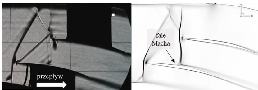
Rys. 6.7. Wizualizacja struktur fal uderzeniowych
