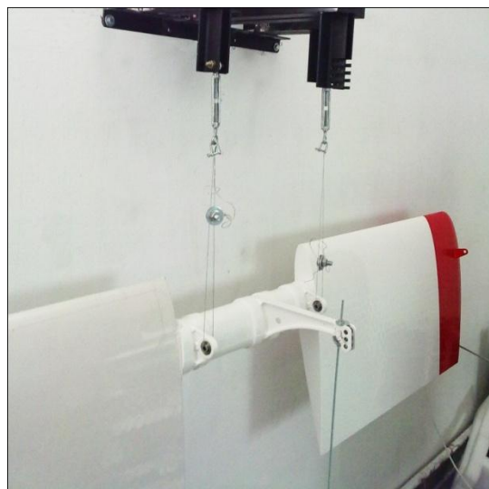
Rys. 10. Mocowanie statecznika na linkach stalowych
